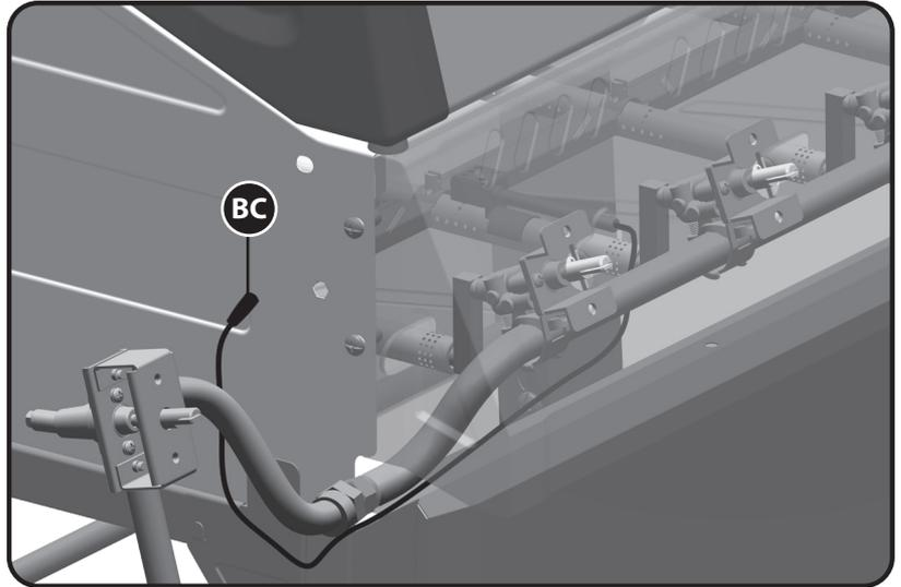
**Attention :** Alimentez le fil d'électrodes du brûleur principal (BC) à travers le trou sur le côté gauche des brûleurs.
